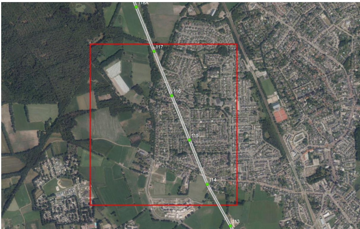
Figuur Fout! Geen tekst met de opgegeven stijl in het document..1 | Zoekgebied kabeltracé tussen mast 114 en mast 117 in de 150 kV lijnverbinding tussen Heeze en Maarheeze.
